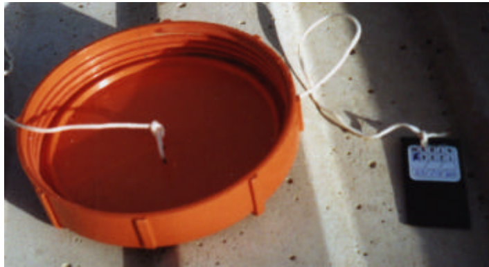
FOTO 4 - Il tappo di chiusura del tubo predisposto con il dosimetro Radon Kodalpha basato su pellicola Kodak LR115
