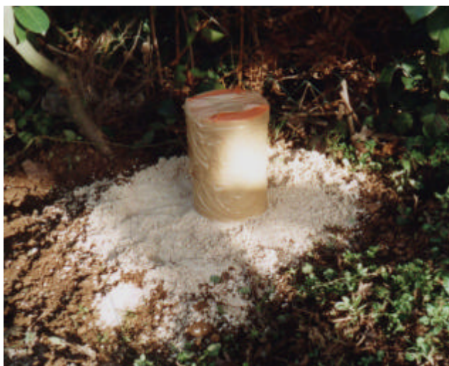
Foto 6 – Il pozzetto sigillato con scotch da imballaggio per l'isolamento con l'esterno e contro aperture accidentali
